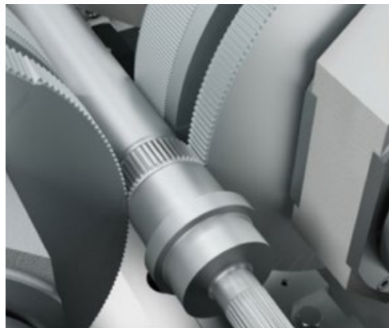
Galaxie® numa máquina de engrenagens – aumento da produtividade de 40% devido ao aumento da velocidade de usinagem
